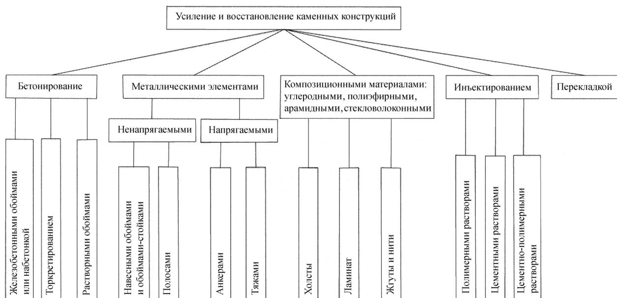
Рисунок 1 – Методы усиления и восстановления каменных конструкций
